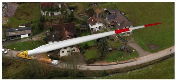
Insgesamt 168 Tonnen wiegt der "Selbstfahrer" samt 68 Meter langem Rotorblatt. Das Foto zeigt die Ausmaße eines Rotorblatts einer neuen Windkraftanlage mit Nabenhöhe 160 Meter. Foto und Bericht hierzu: <a href="https://www.tagesschau.de/wirtschaft/technologie/windkraft-trans-port-100.html">https://www.tagesschau.de/wirtschaft/technologie/windkraft-trans-port-100.html</a>
